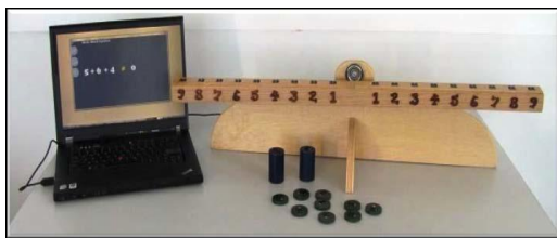
รูปที่ 11. ส่วนติดต่อกับผู้ใช้แบบจับต้องได้ในลักษณะคานทรงตัวสำหรับการเรียนการสอนเกี่ยวกับสมการทางคณิตศาสตร์
