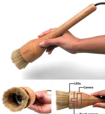
รูปที่ 1. ส่วนติดต่อกับผู้ใช้แบบจับต้องได้ของระบบ I/O Brush ซึ่งมีลักษณะคล้ายพู่กัน ทำให้ผู้ใช้สามารถเรียนรู้และใช้งานระบบวาดภาพได้ง่ายยิ่งขึ้น
